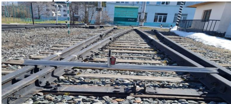
Рисунок 1 – Бесконтактный измеритель параметров контактной сети на базе лазерного измерителя расстояний
